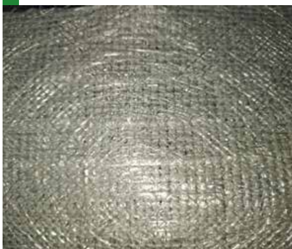
FOT. 2 Kompozyt, z którego produkuje się nowoczesne produkty do CIPP
