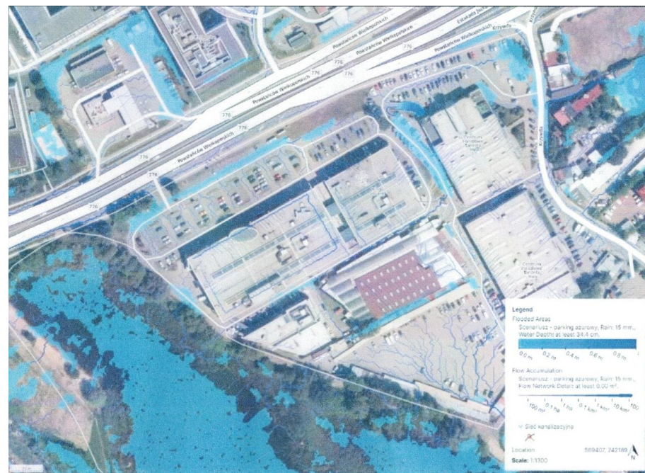
Rysunek 7.5. Analiza wykonana przy użyciu aplikacji SCALGO Live obrazująca ścieżki spływu oraz potencjalne miejsca akumulacji wód deszczowych na obszarze studialnym I – Staw Płaszowski (opracowanie własne)
